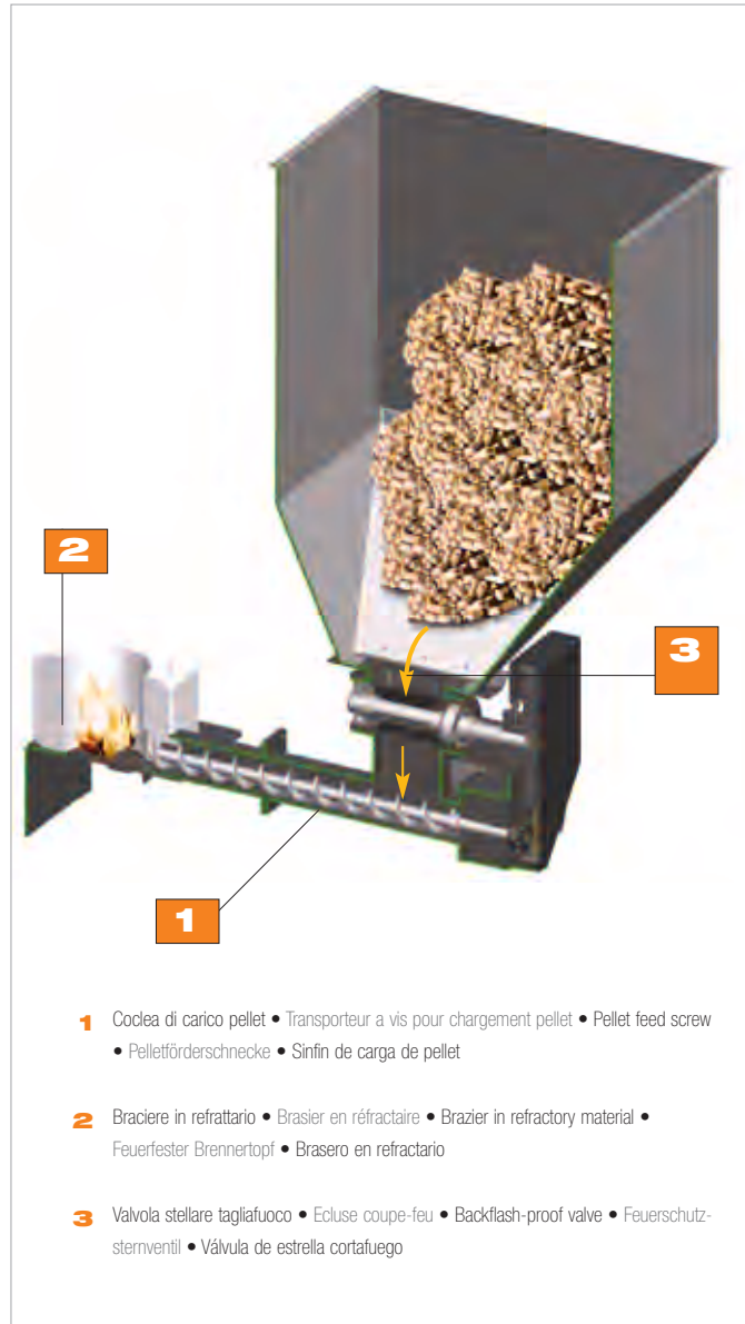
Immissione del pellet con valvola stellare tagliafuoco per TP 30 e TC 30 • Introduction du pellet avec écluse rotative coupe-feu pour TP 30 et TC 30 • Pellet introduction with fire-stop star valve for TP 30 and TC 30 • Pelletzufuhr mit Brandschutz-Sternventil für TP 30 und TC 30 • Introducción del pellet con válvula rotativa cortafuego para TP 30 y TC 30
